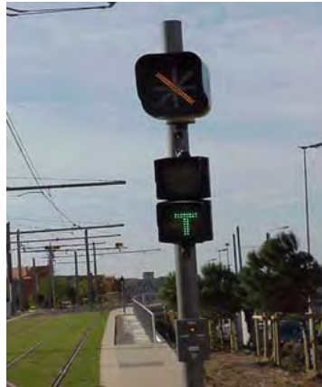
Figure 14 : Photo avec un indicateur de position d'aiguille (en haut) et un signal rouge/vert
